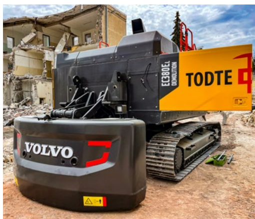
Das acht Tonnen schwere Kontergewicht lässt sich für den Transport hydraulisch absenken und abnehmen.
